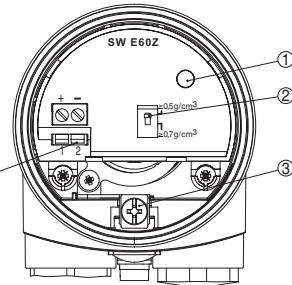
Отсек электроники и подключения (однокамерный корпус)
